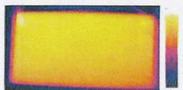
新素材 グラフェンセル 面で温めるため効率的に温まる
